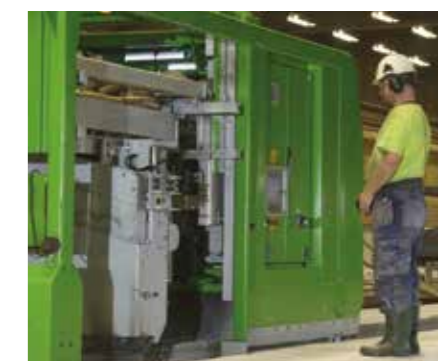
Дистанционное управление операциями обеспечивает повышенную гибкость управления операциями (например, одновременная работа с покрытием или компоновка плит) и позволяет находиться вдали от источника шума.
